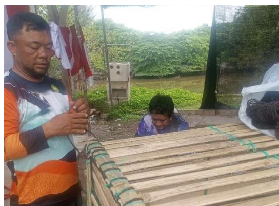
Gambar 4. Proses pembuatan media bubu yang terdiri dari tahapan pembuatan kerangka, perangkaian dan pemasangan bambu dan pengikatan tali ijuk
