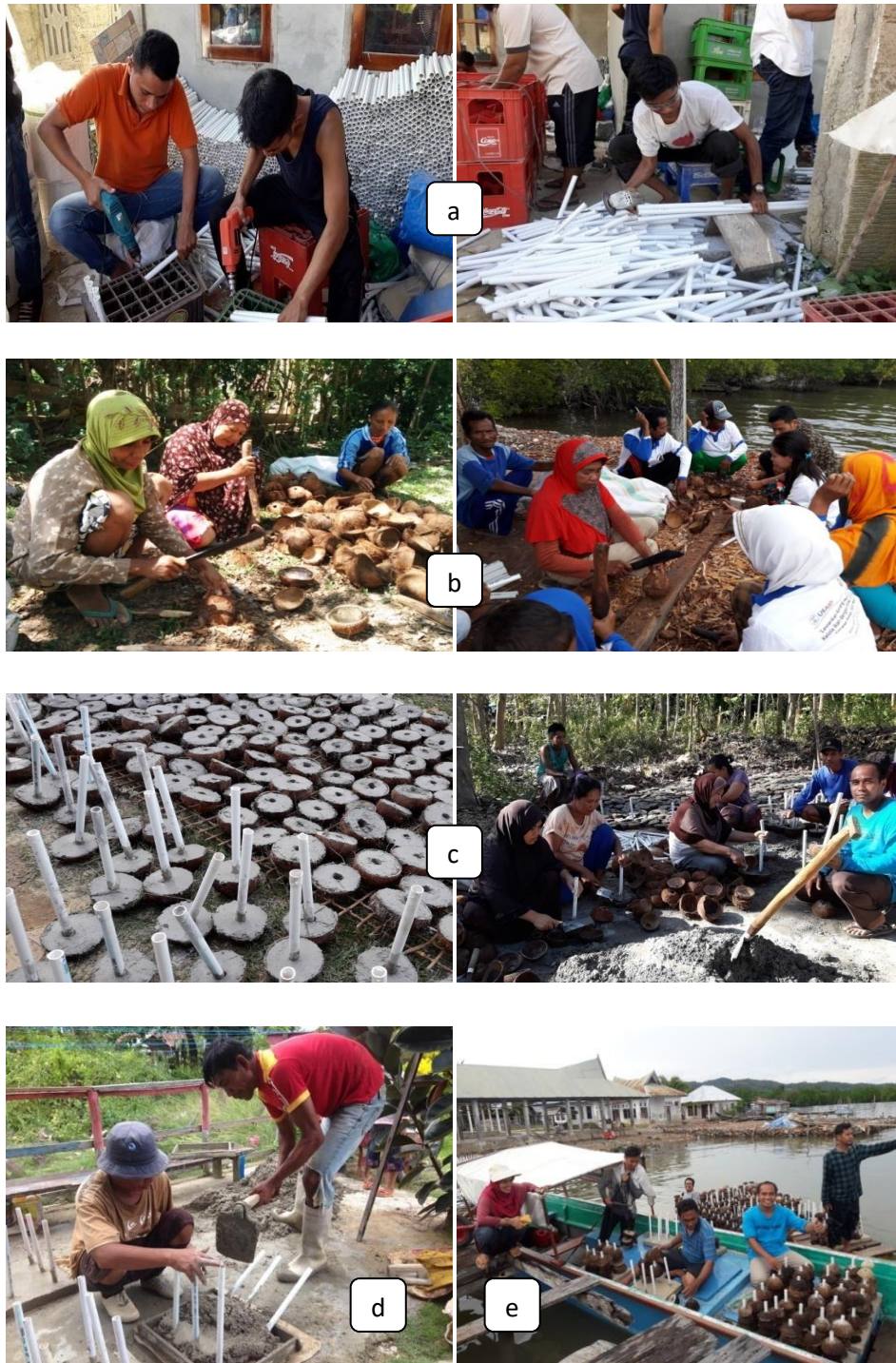
Gambar 4. Proses pembuatan teknologi bioreeftek: a) pemotongan pipa paralon, b) pembuatan lobang batok kelapa, c) pengisian campuran cor pada batok kelapa, d) pembuatan dudukan Bioreeftek, e) penyusunan batok kelapa ke media Bioreeftek.
